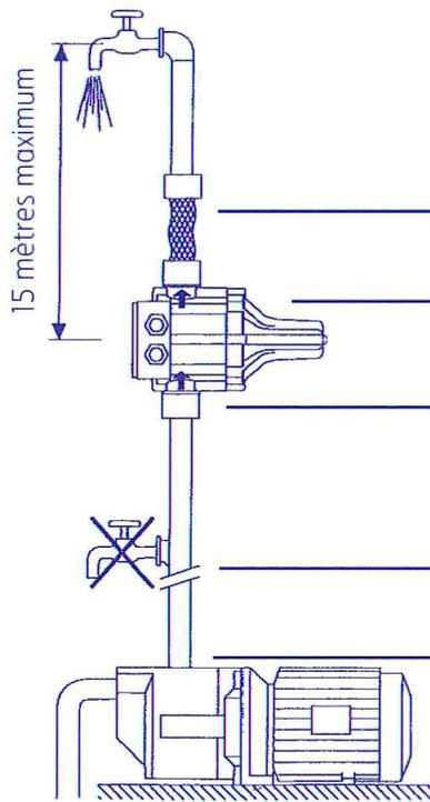
Le montage d'un flexible en sortie du Presscontrol est conseillé.
